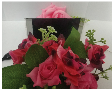
图3 样品1通电后另一侧的遮光黑态
