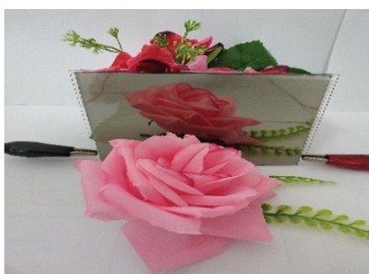
图5 样品2通电后的遮光镜子态
