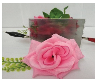
图8 样品3通电后的遮光雾态
