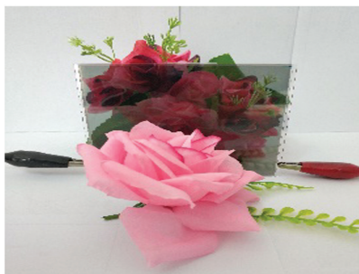
图4 样品2通电前的半透明态
