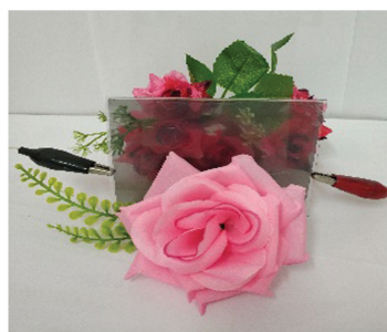
图7 样品3通电前的半透明态
